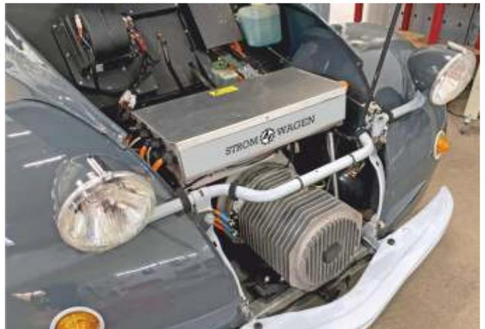
Elektromotor und Steuerelektronik unter der Haube
