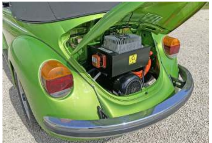
Ein moderner Elektroantrieb ersetzt den alten Boxermotor
